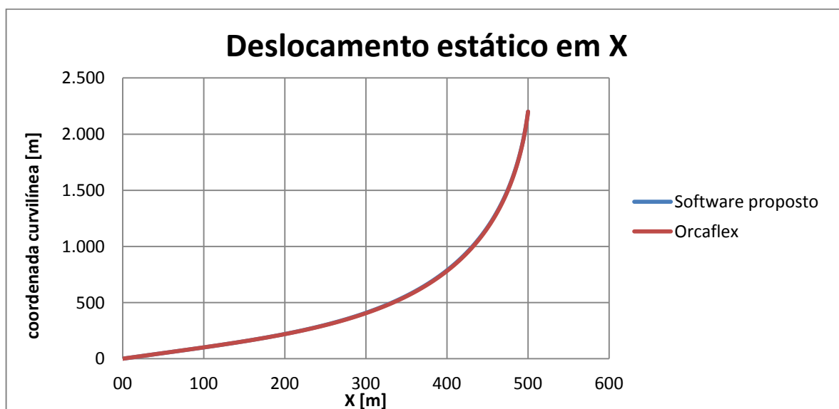
Figura 9.11 - Configuração estática do riser estudado, estudo de caso 2, para o software comercial Orcaflex e o proposto.
