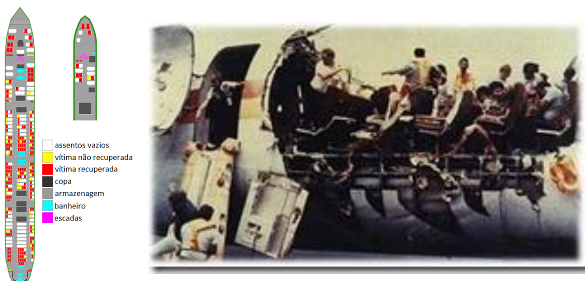
Figura 7.1 - Imagens de alguns acidentes devido à fadiga. Na esquerda tem-se o esquema do mapa da aeronave da China Airlines voo 611 que sofre falha por fadiga em 2002 e todos os passageiros morreram e na direita o Boeing 737 da Aloha Airlines no fim da década de 80 [19].
