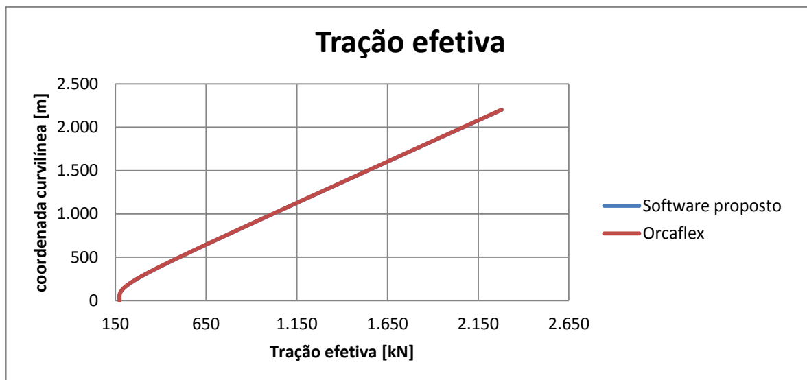
Figura 9.12 - Comparação da tração efetiva do riser estudado, estudo de caso 2, para o software comercial Orcaflex e o proposto.
